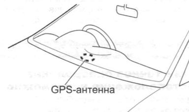
Местоположение Вашего автомобиля определяется при помощи антенны GPS, которая принимает слабые радиосигналы от спутников GPS.
