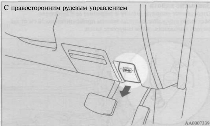
Поднимите капот, нажав на рычаг предохранительного крюка.
