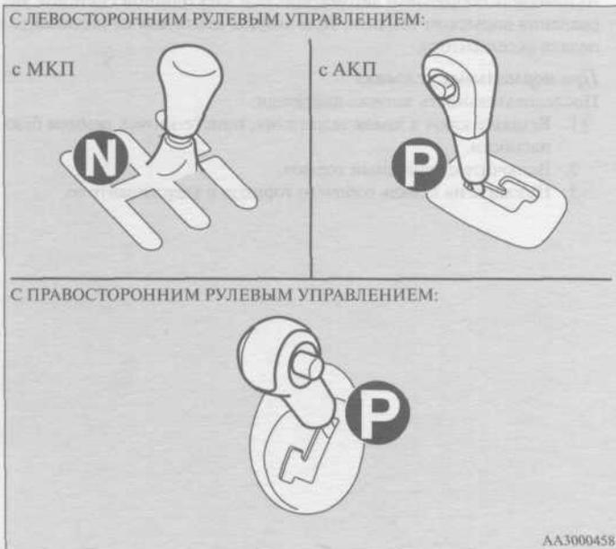
5. Нажмите до упора педаль сцепления (на автомобиле с механической коробкой передач).
