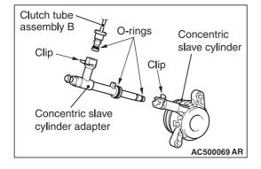
CONCENTRIC SLAVE CYLINDER ADAPTER/CLUTCH TUBE ASSEMBLY/CLIP <RHD> INSTALLATION
